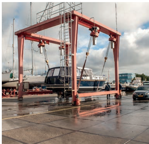
De kraan van Brandsma Jachten kan schepen tot 40 ton uit het water tillen.
